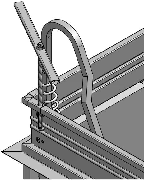
Il tenditore di sostegno botola è solidamente ancorato al nervo-telaio e all'angolare di fissaggio.
