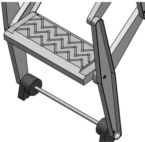
L'antiskid sulla pedata è migliorato dalla particolare geometria della modanatura. L'ampia pedata, anche nella misura 50, aumenta il confort di utilizzo. Un appoggio stabile della scala è assicurato dalla barra stabilizzatrice sulla quale sono montati i piedini antiskid.
