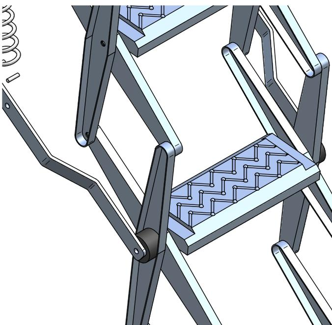
Le ruote mille righe in plastica rendono l'apertura del pantografo estremamente fluida.
